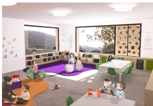
Les salles sont lumineuses, avec des fenêtres à ouverture manuelle sur des parois ajourées laissant passer l'air sans mettre les enfants en danger
